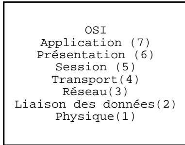
**Couche physique (1)** La couche physique transfère les bits à travers un canal de communication. Ses bits encodés peuvent être en numérique mais aussi en analogique. Cette couche transmet les bits venant de la couche de données à l'interface physique et inversément. (support physique : Paire torsadée, coaxial, FO...)
